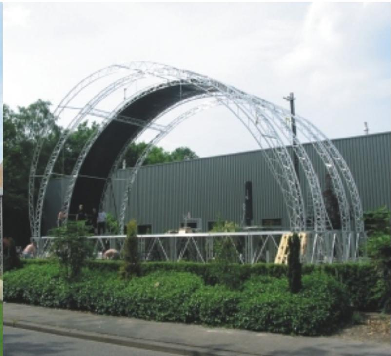
Туннельная крышная система имеет два стандартных размера арки H30D для небольших крыш и арки H40D для более крупных. С помощью двух типов уголков Вы можете создать сцену шириной 12 метров и арками H30D высотой в 6 метров или H40D высотой в 8 метров. Глубина сцены также может варьироваться секциями по 2 метра. Каждые 5 секций поддерживаются оттяжками. На глубину сцены нет никаких ограничений.
