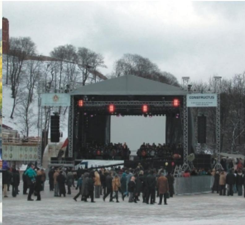
Крышная система МРТ использует стандартные опорные башни МРТ в сочетание со скатной крышей, что гарантирует готовой конструкции оптимальную прочность.
