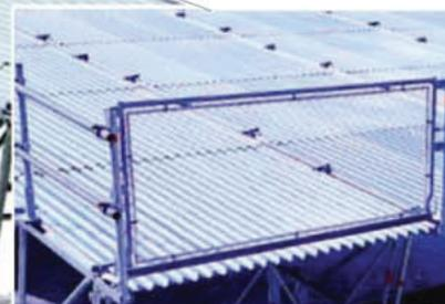
Безопасность работ и нахождения на крыше быстро обеспечивается установкой стандартных элементов. Они монтируются на земле и не требуют винтовой сборки — рейлинги вдоль фронтонов и перила вдоль свесов крыши. Возможна установка дорожек и проходов для частных выходов на крышу.
